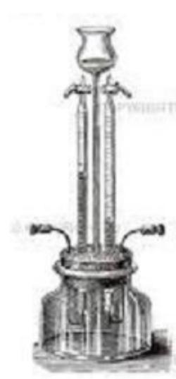
Elettrolisi dell'acqua e voltametri
