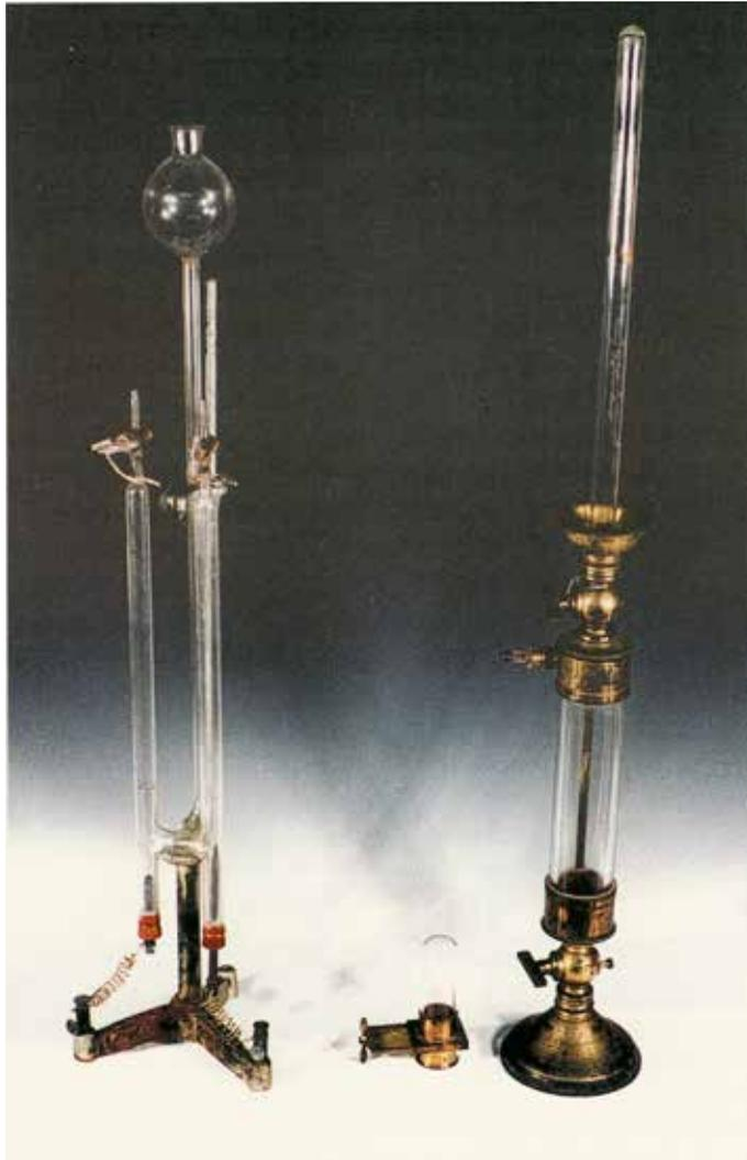
Sul finire del XVIII secolo gli studi e le ricerche intorno ai fenomeni elettrici culminarono con l'invenzione della pila di Volta. In campo chimico si intuì subito la possibilità di far avvenire reazioni per mezzo dell'elettricità (sia statica che dinamica). A tal fine vennero costruiti apparati che permettevano la realizzazione di sintesi e dissociazioni quali gli eudiometri ed i voltmetri.
