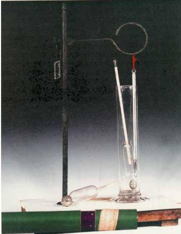
I densimetri e gli areometri sono ancora oggi ampiamente utilizzati in campo enologico perché permettono rapide misure durante i processi di vinificazione, senza dover ricorrere all'acquisto di costose e complicate strumentazioni.
